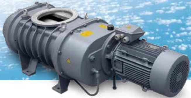
ZRS系列机械增压泵基于罗茨原理，机械增压泵是压力范围为0.01至10 mbar需要大抽速的应用中广受欢迎的类型。一般需要配套一台前级泵使用，前级泵可以预抽到增压泵的启动压力。机械增压泵运行压
